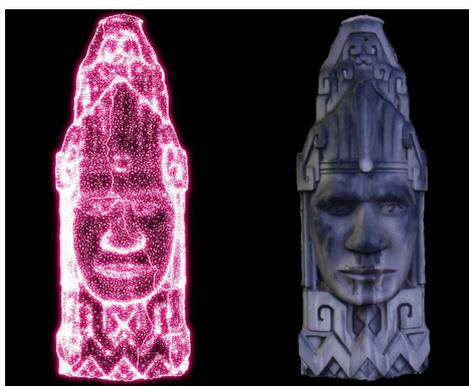
Figura 1: a esquerda exibe a nuvem de pontos obtida, fazendo revelar os detalhes da escultura da fachada do primeiro arranha-céu de Belo Horizonte e a direita o modelo digital com as fotografias estampada no modelo. (Foto: imagem exportado do software Autodesk® Remake, em abril de 2017)
