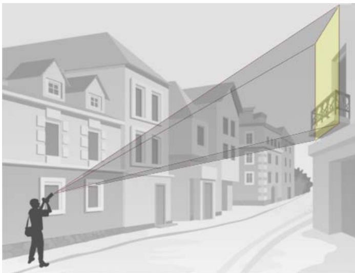
Figura 03: Esquema demonstrativo do processo de fotogrametria. (Fonte: EquipeB).
