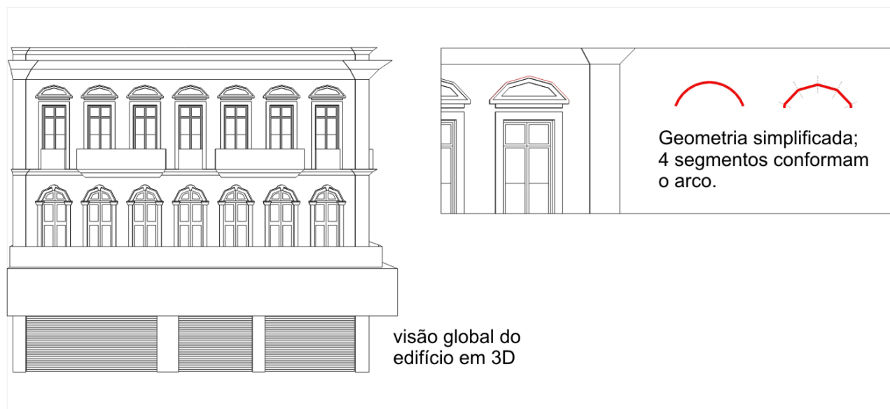
Figura 04: Simplificação geométrica aplicada para construção de modelos com poucos polígonos. (Fonte: EquipeB).
